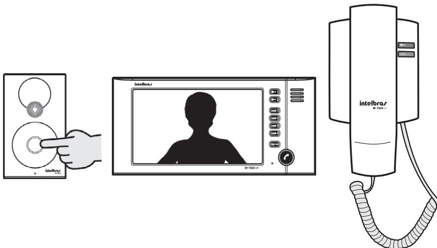
Para realizar o atendimento com a extensão IV7000 EA basta retirar o monofone do gancho, abrindo assim a comunicação com o módulo externo do videotelefone.
