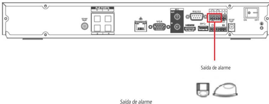
Quando utilizar as saídas de alarme, forneça alimentação ao dispositivo conectado às mesmas através de uma fonte externa. Para evitar sobrecarga, leia as informações da tabela *Especificações do relé*, exibida a seguir.
